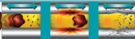
油系统中颗粒物和水的污染将导致不同的问题，这些问题会引起机械失效，频繁的设备修理，以及油品寿命的缩短。长此以往，会产生生产效率低下，不必要的修理费用以及频繁的更换油品等一系列问题。
