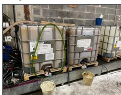
L'huile « usagée » est transférée dans des IBC de 1.000 litres. Le sédiment de fond des boues et de l'eau libre est régulièrement purgé via la vanne de vidange des conteneurs IBC.
